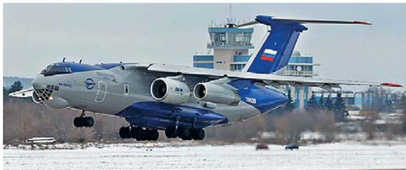
Испытания двигателя ПД-14 на летающей лаборатории Ил-76ЛЛ в АО «ЛИИ им. М.М. Громова», 2016 г.
